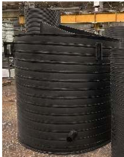
Пластиковые колодцы являются прекрасной альтернативой колодцам из железобетона, не уступая им ни по функциональности, ни по эксплуатационным характеристикам. Завод производит колодцы двух видов: сборные и сварные.
